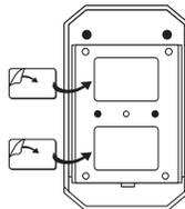
**OPTION 2 :** Utiliser les deux vis et les ancrages inclus afin de fixer le support coulissant au mur, à l'endroit désiré, comme illustré (fig. 3).
